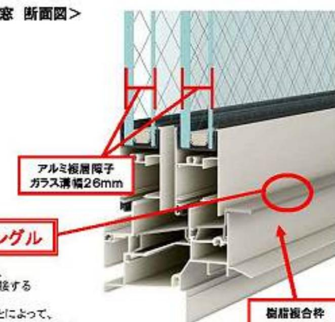
室内クロスや、木縦線と直に接するアングル部を複層にすることによって、結露の発生を抑制します!!
